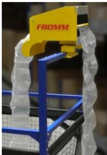
Programme permettant le réglage du gonflage des coussins ainsi que la vitesse de production de ceux-ci (93 coussins minimum par minute)
